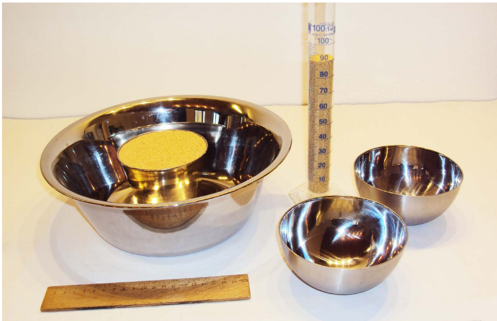
Abbildung 2: Mess- und Schüttgefäße zu Volumenmessung nach dem Verdrängungsprinzip
